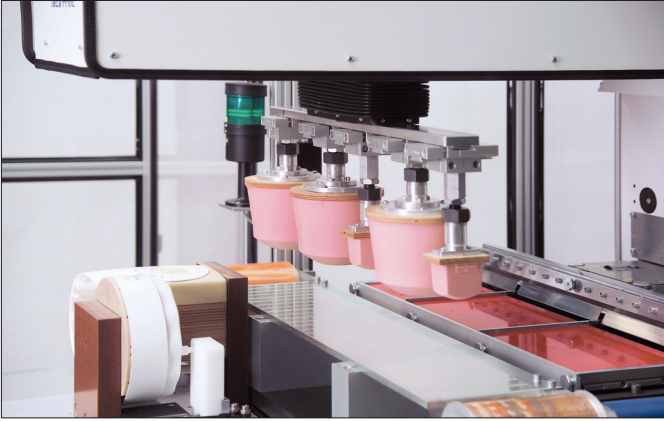
TPX 550 - 6-Farbendruck - mit Transfert Carré und Tamponreinigung TPX 550 - 6 color print - with Transfert Carre and pad cleaning device
