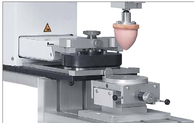
Pendeltisch PT 300 mit Feineinstellung FE 80 an TPE 151 Swingtable PT 300 with vernier adjustment FE 80 on TPE 151
