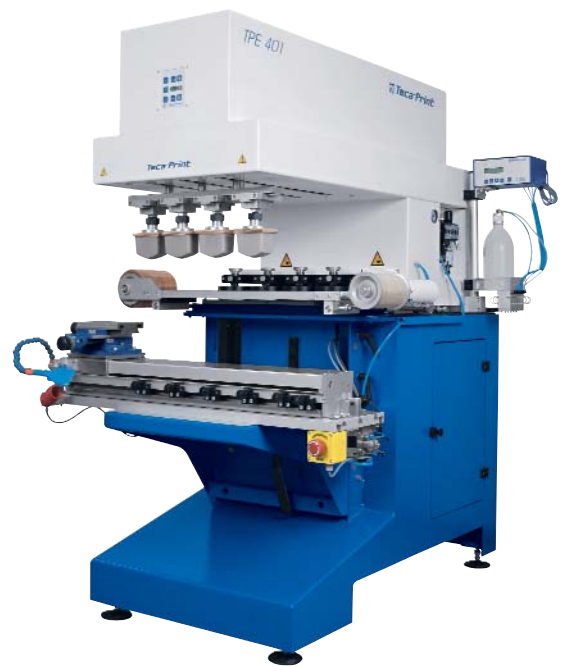
TPE 400 mit Tamponreinigung TAC und Koordinatentisch MG 0 TPE 400 with pad cleaning device TAC and coordinate table MG 0
